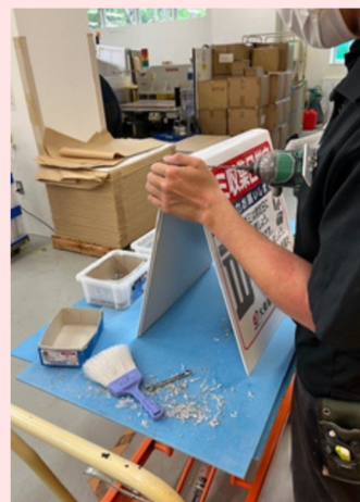
電動工具での作業は巻き込みの危険がある為、軍手等は嵌めずに作業しています。
